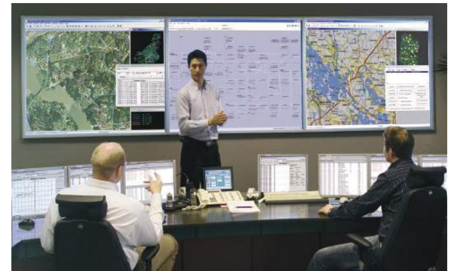
DMS600 выполняет управление переключениями и электрическим режимом сети в реальном масштабе времени с помощью графического пользовательского интерфейса, позволяет выполнять моделирование сети; программный пакет может работать как в локальной вычислительной сети по технологии клиент-сервер с резервированием, так и на одной рабочей станции. В качестве сервера реляционной базы данных используется MS SQL Server или Oracle.
